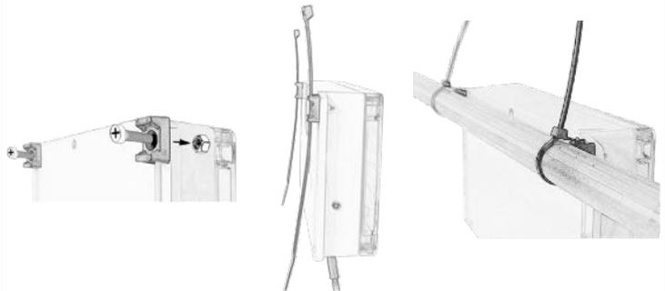
Fixer les 2 consoles sur le D-CALC au moyen des deux vis & écrous.
