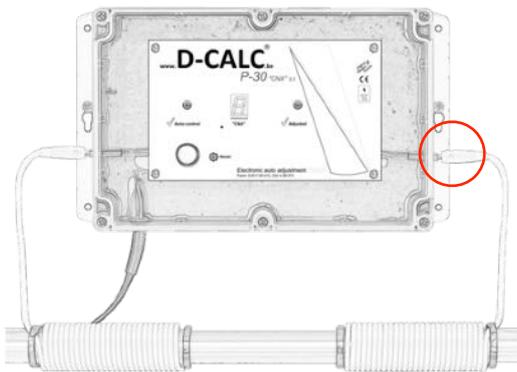
2. Brancher les câbles d'induction dans les côtés de l'appareil.
