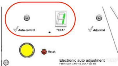
6. Vérifier si la LED verte "AUTO-CONTROL" est éteinte. Si ce n'est pas le cas, l'éteindre en poussant une fois l'interrupteur à membrane "RESET".
